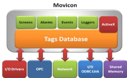
Schema a blocchi dell'architettura.
