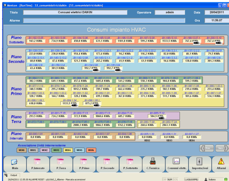
Figura 4 – Tipico di visualizzazione dei consumi impianti HVAC
