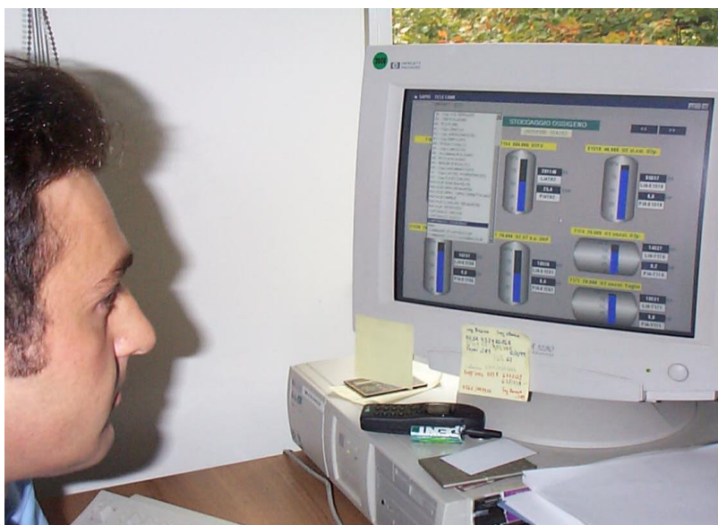
Una postazione telemetrica basata su Movicon Web Client, posta negli uffici della divisione di ingegneria di Monza (MI). Tramite la tecnologia Web Client, l'ufficio è connesso al server Movicon sul quale confluiscono i dati del sistema telemetrico.
