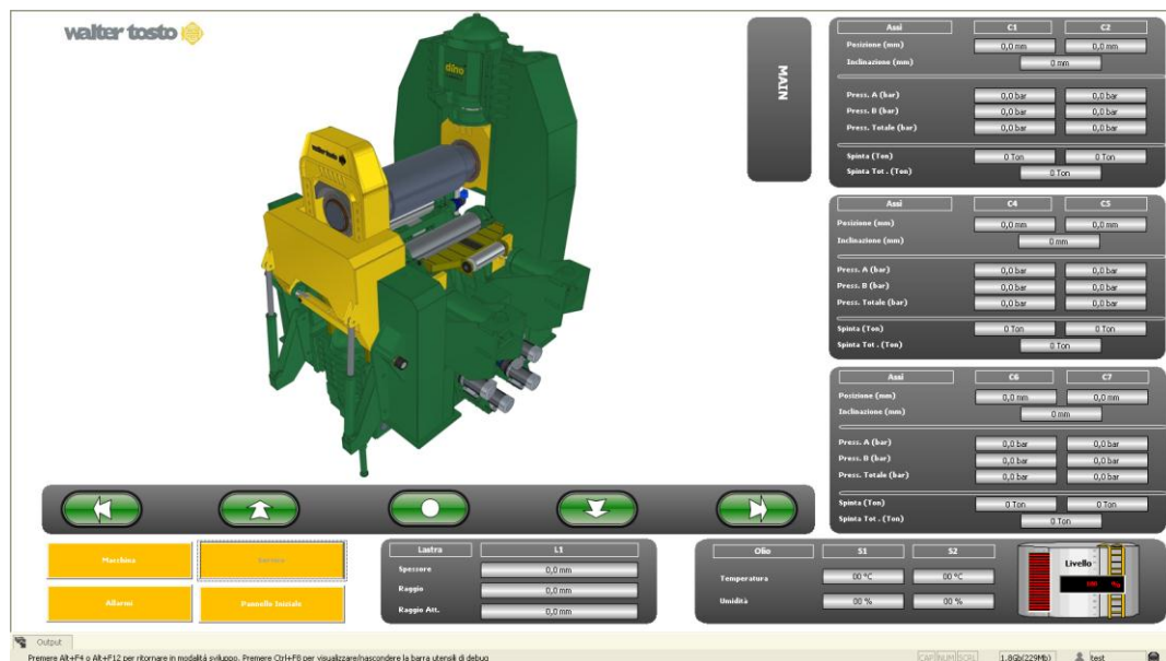
Il sistema di supervisione che controlla la macchina per calandre più grande del mondo è basato su Movicon 11.
