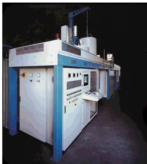
Fig. 1: Vista frontale del sistema brevettato System Pat di Refrattari Brebbia, innovativo sistema per il trattamento termico degli acciai e delle leghe leggere .
